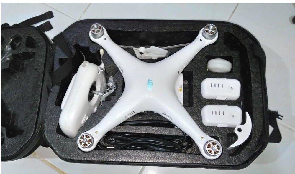
ภาพที่ 5 แสดงอากาศยานไร้คนขับรุ่น dji Phantom 3 Standard พร้อมแบตเตอรี่สำรองและรีโมทบังคับอากาศยาน ซึ่งเป็นรูปแบบ 4 ใบพัด
