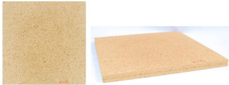
ภาพที่ 8 แผ่นไม้ปาร์ติเกิลแกนกัญชง โดยใช้ตัวประสานจากครั้ง
