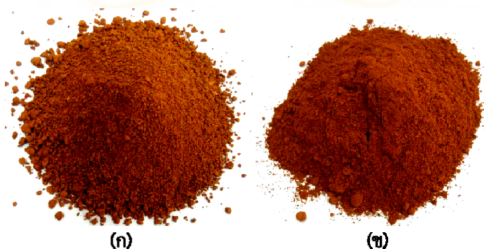
รูป 2 ลักษณะทั่วไปของตะกอนน้ำบาดาล (ก) จากแหล่งธรรมชาติ และ (ข) หลังการปรับปรุง
