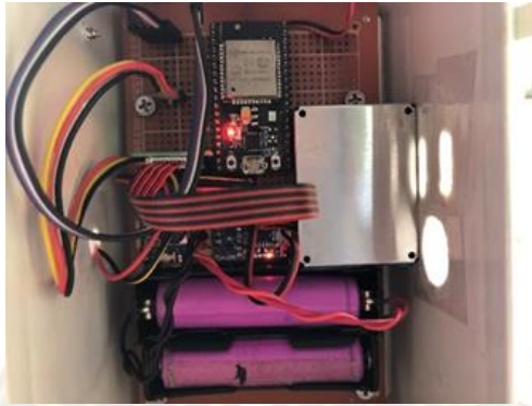
ภาพที่ 6 การเชื่อมต่อแผงวงจรของเครื่องตรวจวัดสภาพแวดล้อมอากาศภายนอกอาคาร
