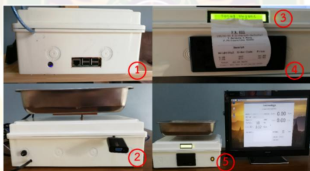
ภาพที่ 4 ส่วนประกอบภายนอกของเครื่องชั่งข้าวสารสำหรับการจัดการคลังข้าวสารแบบอัตโนมัติ
