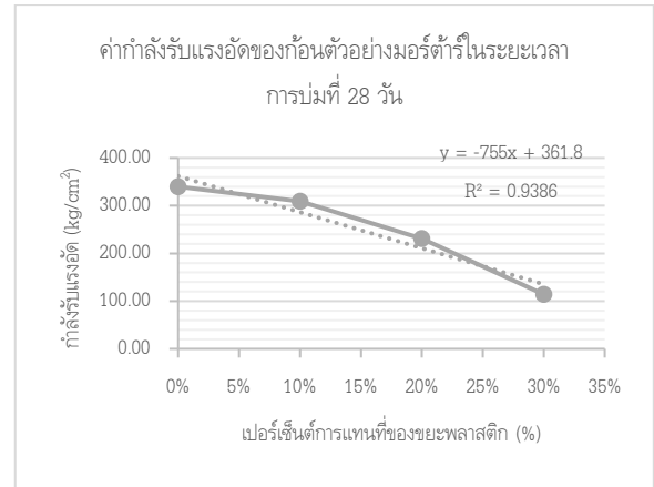
ภาพที่ 6 รูปแสดงสมการการทดสอบแรงอัดของก้อนตัวอย่างมอร์ต้าใน ระยะเวลาการบ่มที่ 28 วัน
