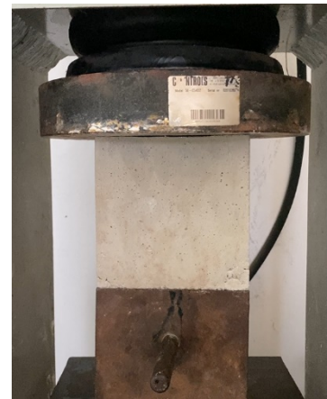
ภาพที่ 10 รูปแสดงการทดสอบหาค่ากำลังรับแรงอัดของก้อนคอนกรีต
