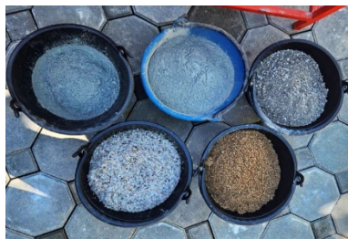
ภาพที่ 1 รูปแสดงวัสดุที่ใช้ในโครงการวิจัย ปูนซีเมนต์ หิน ทราย และขยะพลาสติกประเภท PET
