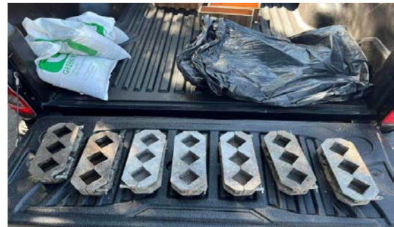
ภาพที่ 4 รูปแสดงแบบบาศก์ที่ใช้ในการทดสอบหาค่ากำลังอัดของมอร์ต้า
