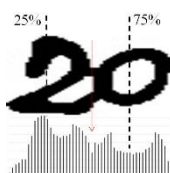
รูปที่ 7 ตัวอย่างฮิสโตแกรมของรูปภาพตัวเลขติดกัน
