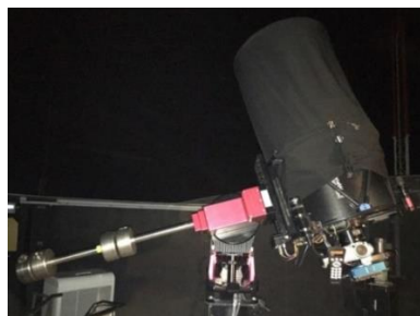
รูปที่ 1 กล้องโทรทรรศน์สะท้อนแสงขนาดเส้นผ่านศูนย์กลาง 0.5 เมตร พร้อมระบบ ซีซีดี โฟโตมิเตอร์
