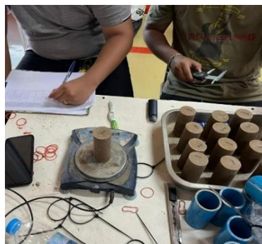
รูปที่ 2 การวัดขนาดชิ้นน้ำหนักรวบรวมเพื่อหาค่าความหนาแน่นรวม
