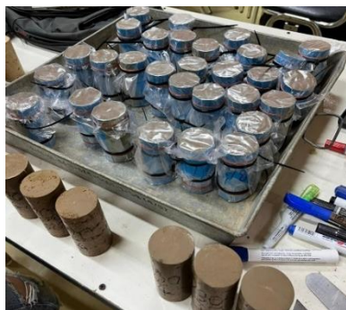
รูปที่ 2 การวัดขนาดชิ้นน้ำหนักรวบรวมเพื่อหาค่าความหนาแน่นรวม
