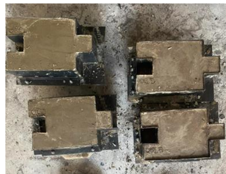
รูปที่ 6 การขึ้นรูปคอนกรีตบล็อกแบบถอดประกอบที่มีส่วนผสมของผงถ่านไม้กระถินณรงค์ในบล็อกหลัก
