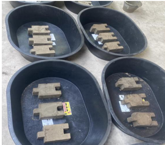
รูปที่ 7 การเตรียมคอนกรีตบล็อกที่มีส่วนผสมของผงถ่านไม้กระถินณรงค์ก่อนนำไปดูดซับสิ่งสกปรกในน้ำ
