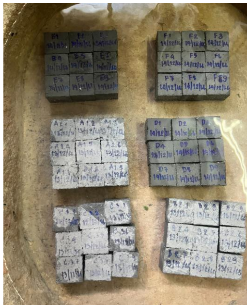
รูปที่ 4 การบ่มคอนกรีตที่มีส่วนผสมของผงถ่านไม้กระถินณรงค์ด้วยการแช่น้ำ
