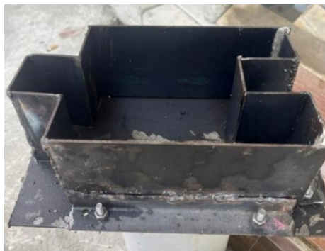
รูปที่ 6 การขึ้นรูปคอนกรีตบล็อกแบบถอดประกอบที่มีส่วนผสมของผงถ่านไม้กระถินณรงค์ในบล็อกหลัก
