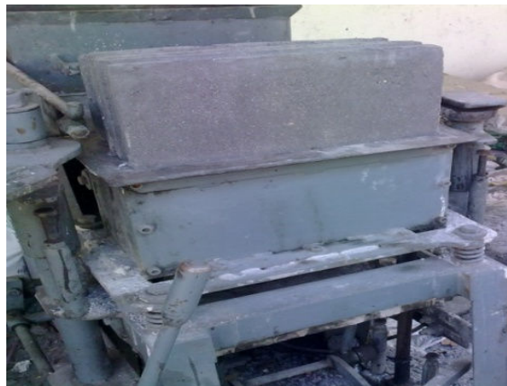
รูปที่ 2 การขึ้นรูปคอนกรีตบล็อกด้วยเครื่องอัดขึ้นรูปคอนกรีตบล็อก
