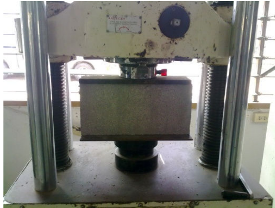
รูปที่ 3 การทดสอบกำลังอัดของคอนกรีตบล็อกดินขาวผสมเถ้าแกลบ (โดยไม่เคลือบผิวบน-ล่าง)
