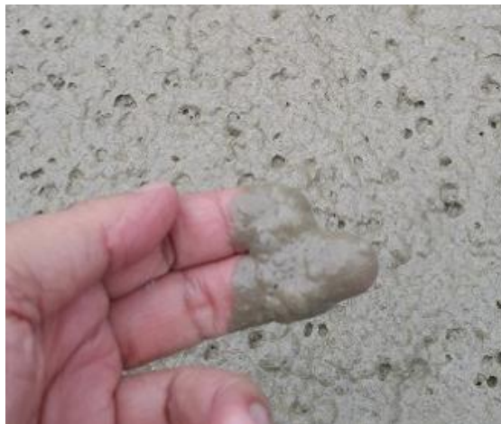
รูปที่ 5 ลักษณะคอนกรีตมวลเบาเหลว
