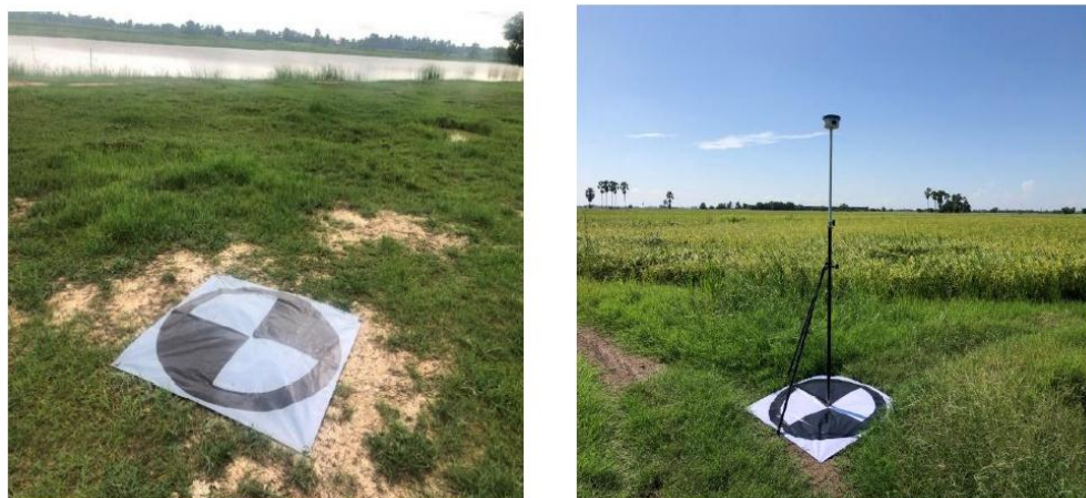
รูปที่ 9 การวางตำแหน่งจุด Check Point
