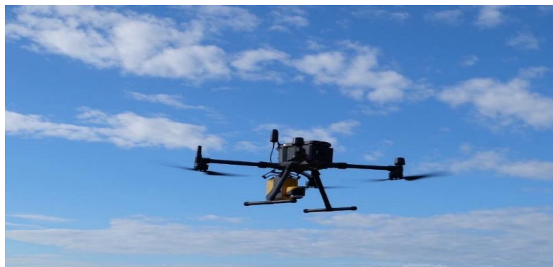
รูปที่ 10 อากาศยานไร้คนดัดตั้งแบบปีกหมุน (UAV) ยี่ห้อ DJI รุ่น MATRICE 300 RTK ติดตั้ง LiDAR
