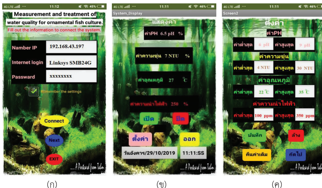
ภาพที่ 3 การแสดงผลบนจอ TFT LCD และสมาร์ทโฟน (ก) การเข้าระบบ, (ข) การแสดงค่าพารามิเตอร์ และการควบคุมระบบ, (ค) การตั้งค่าพารามิเตอร์เพื่อควบคุมระบบ
