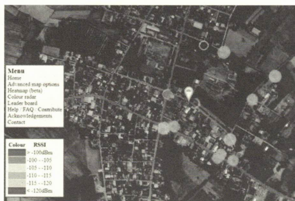
ภาพที่ 6 ระยะของการส่งข้อมูลการแจ้งเตือนการสั่นสะเทือนผ่านช่องทางอินเทอร์เน็ตสรรพสิ่ง (IoT) ด้วยเทคโนโลยี LORA
