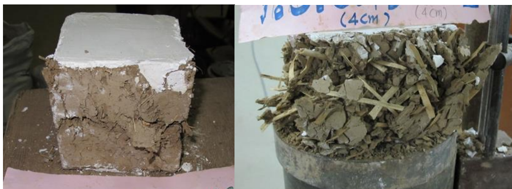
ภาพที่ 12 การวิบัติด้วยพฤติกรรมแบบเหนียวของอิฐดินดิบผสมใบหูก้าแฝกภายใต้แรงอัด
