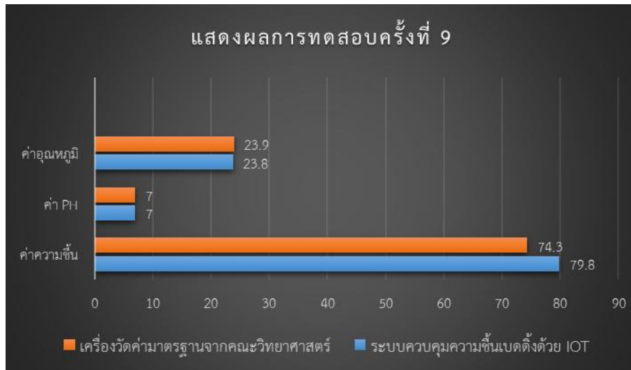
ภาพที่ 13 ผลการทดสอบการวัดค่าความชื้นเบตติงด้วยระบบ IoT เพื่อเปรียบเทียบกับเครื่องวัดความชื้นมาตรฐานทุก ๆ 1 นาที รวม 15 นาที (ครั้งที่ 9)
