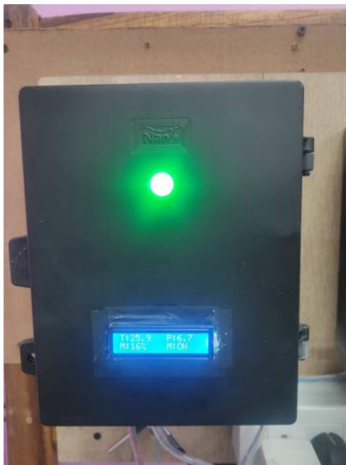
ภาพที่ 2 ภาพด้านหน้าตู้คอนโทรลชุดควบคุมความชื้นเบตดิ่งด้วยระบบ IoT
