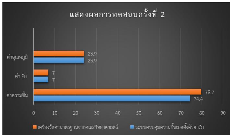
ภาพที่ 6 ผลการทดสอบการวัดค่าความชื้นเบตดั้งด้วยระบบ IoT เพื่อเปรียบเทียบกับเครื่องวัดความชื้นมาตรฐานทุก ๆ 1 นาที รวม 15 นาที (ครั้งที่ 2)
