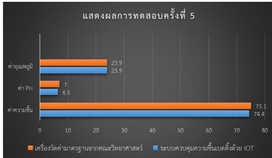
ภาพที่ 9 ผลการทดสอบการวัดค่าความชื้นเบตดั้งด้วยระบบ IoT เพื่อเปรียบเทียบกับเครื่องวัดความชื้นมาตรฐานทุก ๆ 1 นาที รวม 15 นาที (ครั้งที่ 5)
