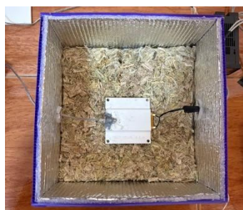
ก. การติดตั้งแผ่นฮีตเตอร์
