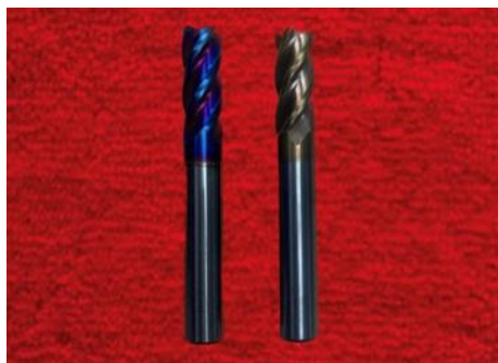
ภาพที่ 3 แสดงภาพดอกกัดจำนวน 2 เกรด คือ ชนิดความแข็ง ค่าความแข็งเกรด 65 HRC และค่าความแข็งเกรด 55 HRC
