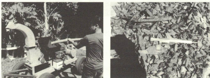
ภาพที่ 14 เครื่องสับย่อยไม้ที่พัฒนาและการสับย่อยไม้
