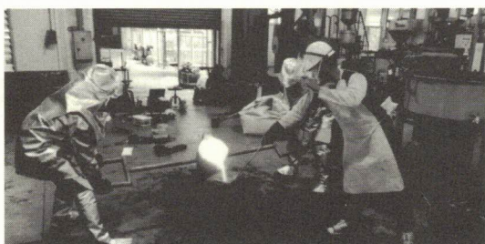
ภาพที่ 13 การหล่อขึ้นรูปประกบใช้กับแบริ่งขนาด 6308
