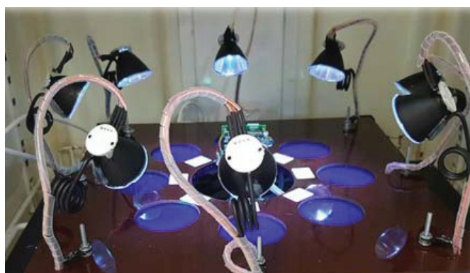
ภาพที่ 4 การปรับสเปกตรัมแสงสำหรับการเพาะเลี้ยงเนื้อเยื่อจากหลอดไฟ LED
