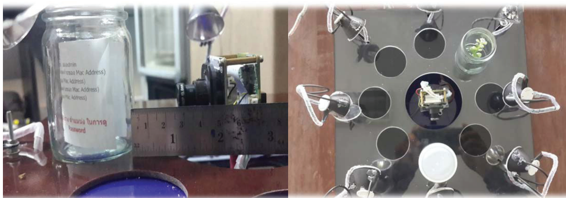
ภาพที่ 3 การกำหนดระยะโฟกัสและตำแหน่งของขวดเพาะเลี้ยงเนื้อเยื่อขนาด 4 ออนซ์
