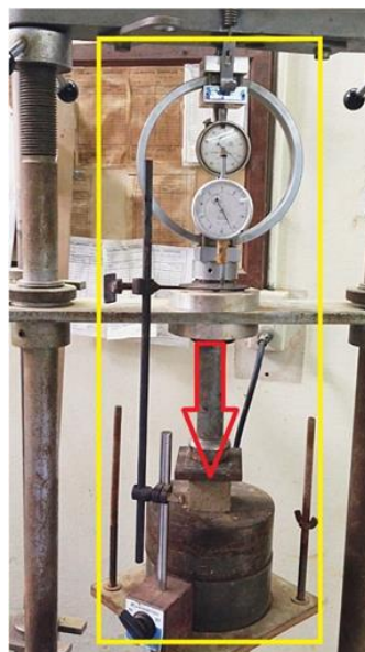
ภาพที่ 2 ขั้นตอนขณะกำลังติดตั้งนาฬิกาวัดค่าการยุบตัว ก่อนการทดสอบกำลังรับแรงอัด และพฤติกรรมแบบเหนียว
