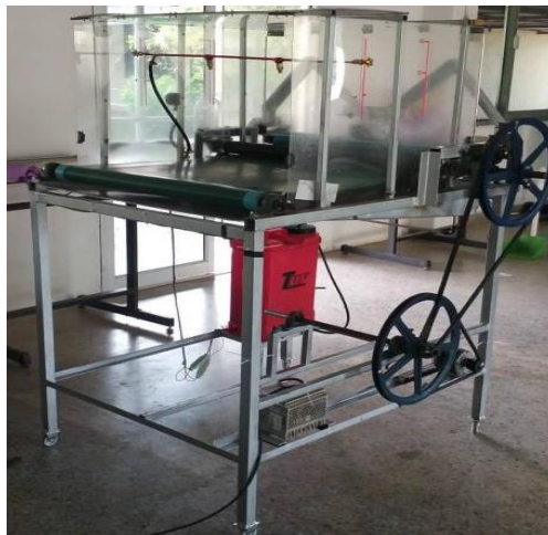
ภาพที่ 5 เครื่องเคลือบสารนาโนสะท้อนน้ำสำหรับผ้าทอพื้นเมือง
