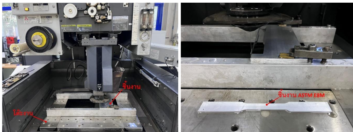
รูปที่ 2 การตัดวัสดุชิ้นงานทดสอบโดยเครื่องตัดโลหะด้วยลวดไฟฟ้า
