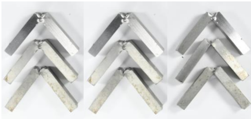
รูปที่ 16 ลักษณะชิ้นงานตัวอย่างภายหลังการทดสอบแรงกระแทก
