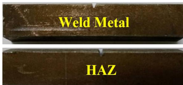
รูปที่ 4 การเตรียมชิ้นงานสำหรับทดสอบการกระแทก
