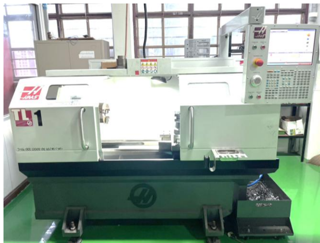
ก) เครื่องกลึงอัตโนมัติที่มีเครื่องหมายการค้าเป็น HAAS รุ่น TL1 ข) เครื่องวัดความหยาบผิวยี่ห้อ Mahr รุ่น MarSurf PS1 รูปที่ 1 เครื่องกลึงอัตโนมัติและเครื่องวัดความหยาบผิวที่ใช้ในการทดลอง
