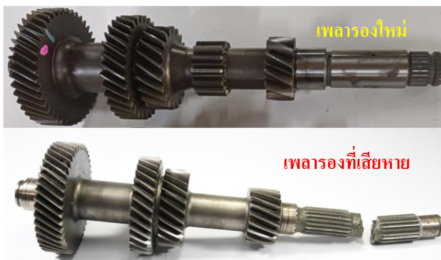
รูปที่ 1 ลักษณะของเฟลารองใหม่และเฟลารองที่เสียหาย
