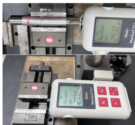
ก) เครื่องกลึงอัตโนมัติที่มีเครื่องหมายการค้าเป็น HAAS รุ่น TL1 ข) เครื่องวัดความหยาบผิวยี่ห้อ Mahr รุ่น MarSurf PS1 รูปที่ 1 เครื่องกลึงอัตโนมัติและเครื่องวัดความหยาบผิวที่ใช้ในการทดลอง
