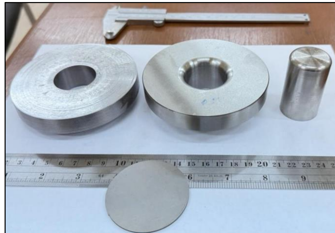
รูปที่ 5 องค์ประกอบของชุดทดสอบการลากขึ้นรูปลึก
