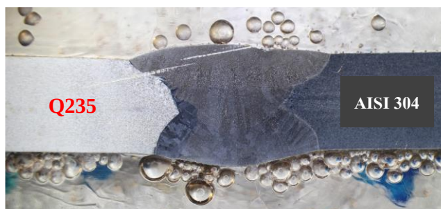
รูปที่ 5 การเตรียมชิ้นงานสำหรับทดสอบความแข็ง
