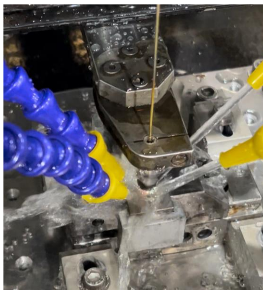
รูปที่ 2 การทดลองเจาะรูขนาดเล็กบนโต๊ะงานเครื่องกัดโลหะด้วยไฟฟ้า
