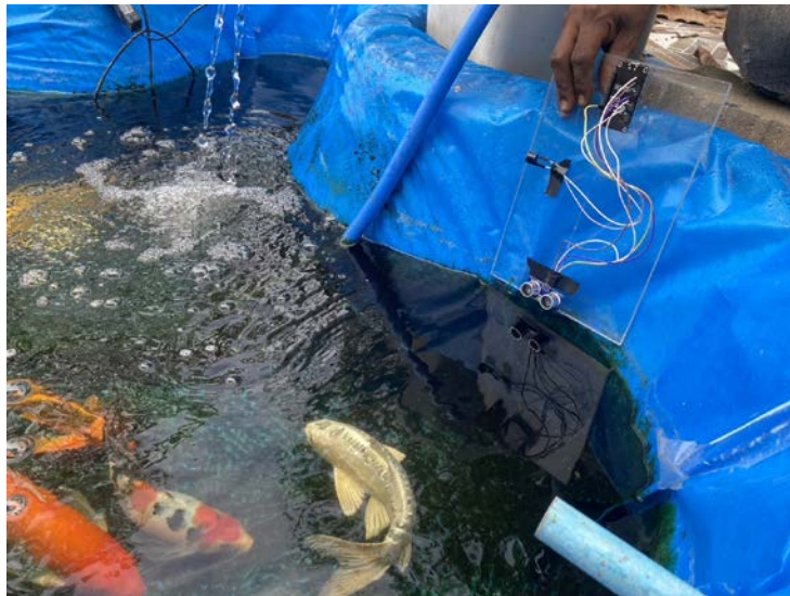
รูปที่ 6 ติดตั้งเครื่องวัดระดับน้ำรอบบ่อ ระยะห่างต่อจุดประมาณ 30 เซนติเมตร เพื่อทดสอบความแม่นยำของอัลตราโซนิกเซนเซอร์
