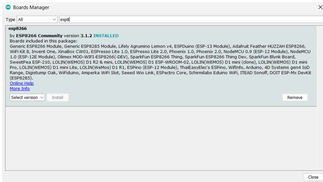
รูปที่ 3 การติดตั้งบอร์ดไมโครคอนโทรลเลอร์ ESP8266 และ ไลบรารีในโปรแกรม Arduino
