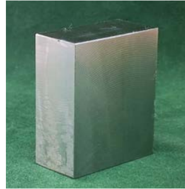
ภาพที่ 2 ลักษณะวัสดุเหล็กแม่พิมพ์ AISI-P20 สำหรับทดลอง
