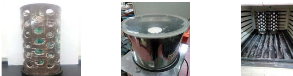
ก. เตรียมกระบอกหล่อ ข. ดูดอากาศออกจากแบบหล่อ ค. การอบกระบอกปูนแบบหล่อ
