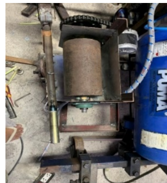
รูปที่ 4 ระบบปล่อยต้นตะไคร้กับระบบลำเลียงต้นตะไคร้
