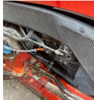
รูปที่ 11 ทำการต่อสายน้ำมันเชื้อเพลิงกับสลิ้ง
