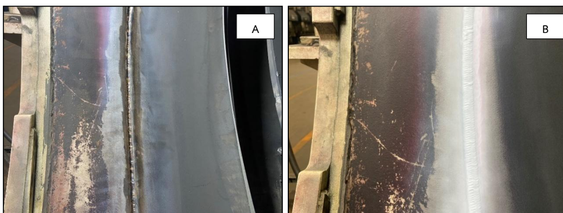
รูปที่ 7 แนวเชื่อมราก (Root Pass) ไม่พบรอยแตกร้าว (A) และ แนวเชื่อมทับหน้า (Cover Pass) ไม่พบรอยแตกร้าว (B)
