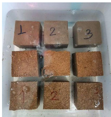
รูปที่ 2 มอร์ตาร์หญาจรจบบ่มน้ำเป็นเวลา 0 14 และ 28 วัน
