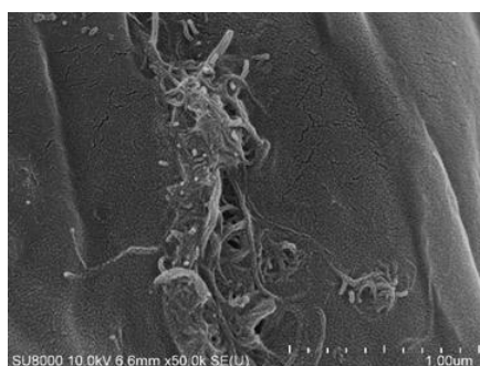
รูปที่ 5 ภาพถ่าย SEM ของอนุภาคคาร์บอนนาโนทิวบ์บนกระดาษนำไฟฟ้าจากใบสับปรด
