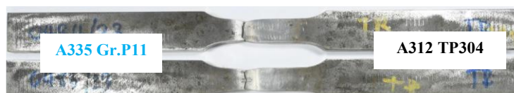
รูปที่ 13 การแตกหักทั้งหมดของชิ้นงานตัวอย่างเกิดขึ้นในบริเวณบริเวณพื้นที่กระแทกร้อน A335 P11 (HAZ) หลังการทดสอบแรงดึง
