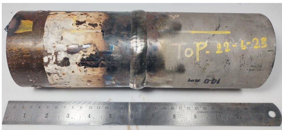
รูปที่ 1 ลักษณะชิ้นงานทดสอบรอยเชื่อมของท่อสำหรับวัสดุ A335 P11 และ A312 TP304 ด้วยกระบวนการเชื่อมอาร์คทั้งสแตนแก๊สปกคลุม
