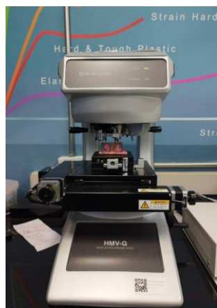
รูปที่ 4 เครื่องทดสอบความแข็ง SHIMADZU รุ่น HMV-G
