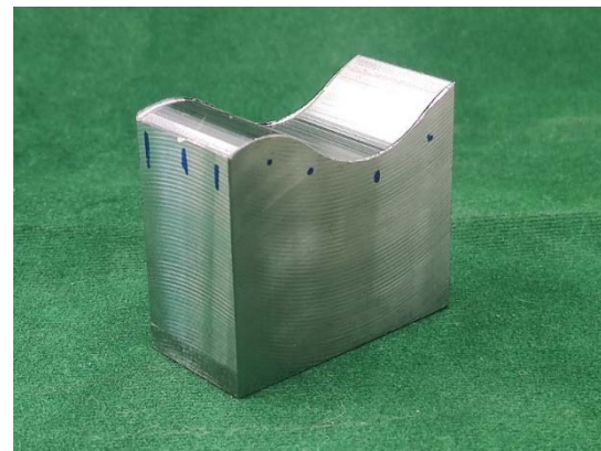
ภาพที่ 4 ลักษณะชิ้นงานขึ้นรูปคลื่นผิวนูนโค้ง
