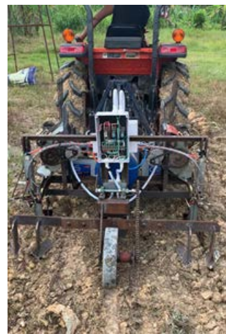
รูปที่ 8 เครื่องปลูกตะไคร้ติดท้ายรถแทรกเตอร์หลังจากพัฒนา
