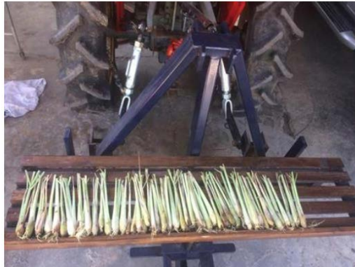
รูปที่ 2 เครื่องจักรปลูกตะไคร้ต้นแบบก่อนพัฒนา
