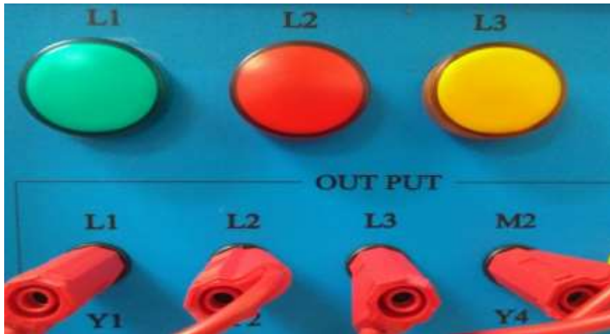
ภาพที่ 7 หลอดไฟแสดงการทำงานของเซนเซอร์
