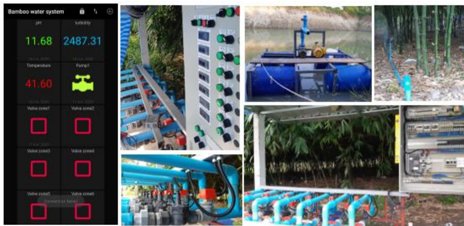
ภาพที่ 2 การออกแบบระบบควบคุมการให้น้ำในสวนไผ่
