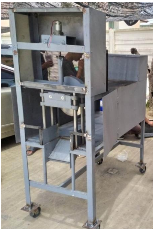
ภาพที่ 10 เครื่องตัดท่อนพันธุ์ไม้สำหรับอัดโน้ตไม้สมบูรณ์ (มุมมองจากทางด้านขวาและซ้าย)
