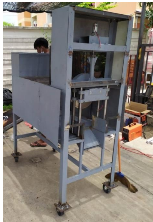
ภาพที่ 10 เครื่องตัดท่อนพันธุ์ไม้สำหรับอัดโน้ตไม้สมบูรณ์ (มุมมองจากทางด้านขวาและซ้าย)
