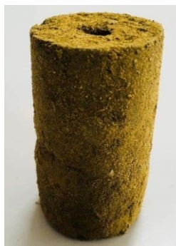
ภาพที่ 5 การผลิตเชื้อเพลิงอัดแท่งจากเศษใบกาสะลองเหลือทิ้ง
