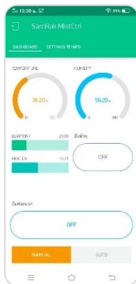
ภาพที่ 9 ทดสอบแอปพลิเคชัน Blynk สำหรับควบคุม IOT ระบบฟ้นละอองน้ำ
