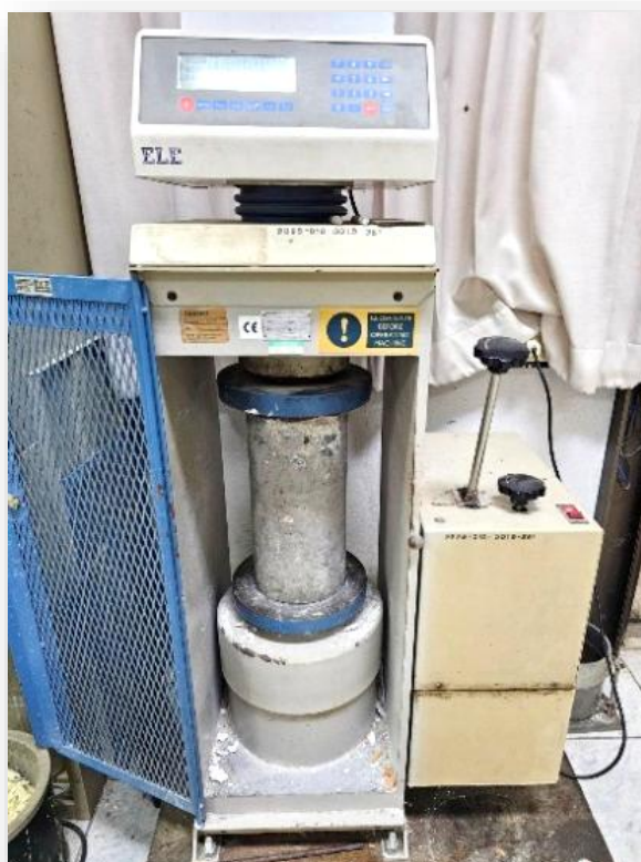
ภาพที่ 2 การทดสอบกำลังรับแรงอัดของแท่งคอนกรีตตัวอย่าง
