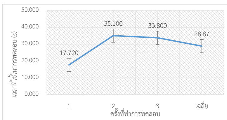
รูปที่ 15. ผลการทดสอบหาเวลาที่ใช้ในระยะทาง 100 เมตร ของรถบรรทุกสามล้อไฟฟ้าดัดแปลง
