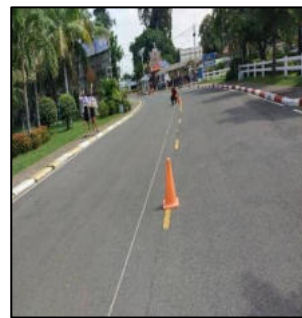
รูปที่ 9 - 10 ทดสอบหาระยะเบรกที่ระยะทาง 50 เมตร โดยใช้ความเร็วที่ 30 กิโลเมตรต่อชั่วโมง
