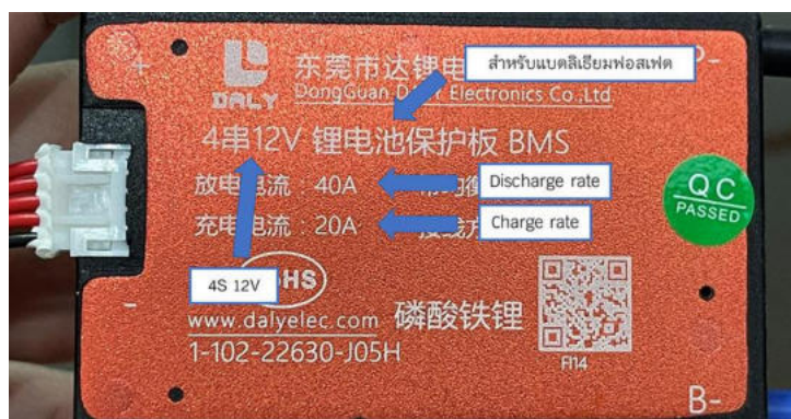
ภาพที่ 3 Battery Management System (BMS)
