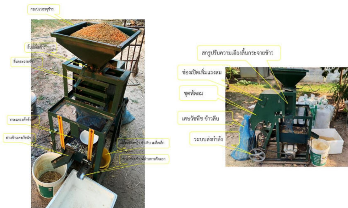
ภาพที่ 1 โครงสร้างและส่วนประกอบของเครื่องคัดแยกเมล็ดข้าวเปลือก
