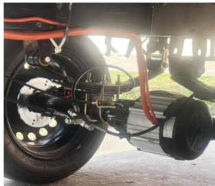
ภาพที่ 11 มอเตอร์ไฟฟ้ากระแสตรงแบบไร้แปรงถ่าน ขนาด 48 โวลต์ 1,500 วัตต์
