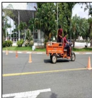
รูปที่ 9 - 10 ทดสอบหาระยะเบรกที่ระยะทาง 50 เมตร โดยใช้ความเร็วที่ 30 กิโลเมตรต่อชั่วโมง
