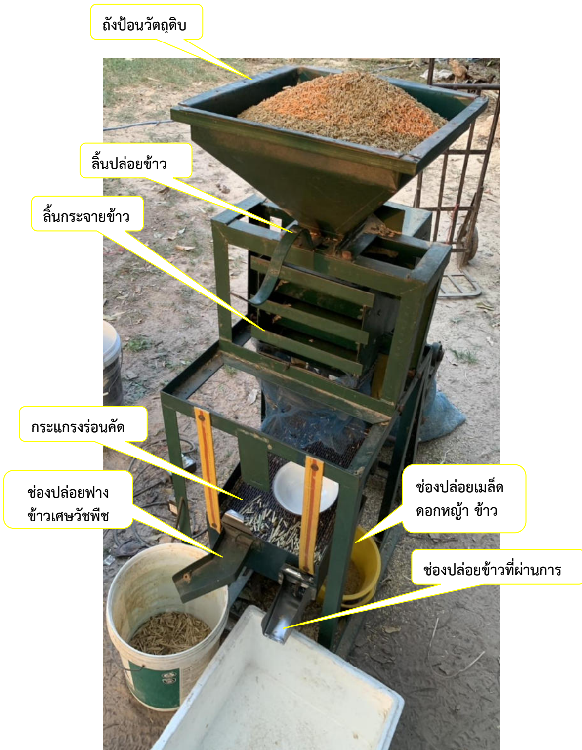
ภาพที่ 4 : ส่วนประกอบเครื่องคัดแยกเมล็ดข้าวเปลือกเปลือกโดยใช้ตะแกรงร้อนร่วมกับลมเป่า
