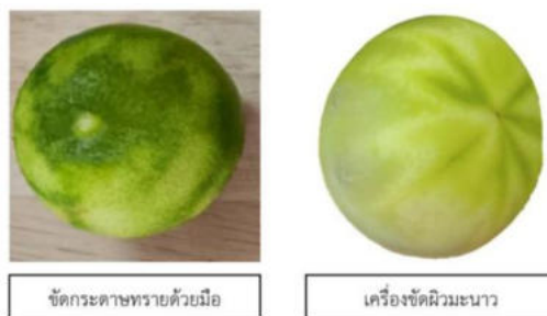
ภาพที่ 8 เปรียบเทียบการตัดผลมะนาวโดยใช้กระดาษทรายเบอร์ P40
