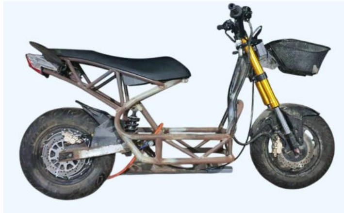
ภาพที่ 4 ประกอบชิ้นส่วนและอุปกรณ์ต่างๆเข้าไปในโครงรถจักรยานยนต์ไฟฟ้า
