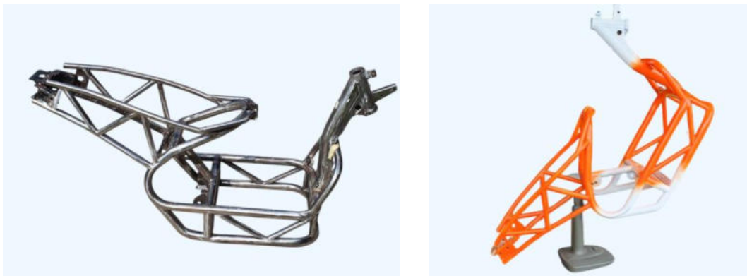
ภาพที่ 3 โครงรถจักรยานยนต์ที่ดัดแปลงโครงรถขึ้นมาใหม่
