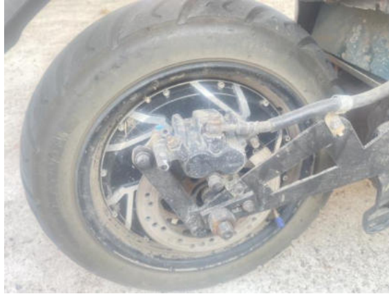
ภาพที่ 6 มอเตอร์ไฟฟ้ากระแสตรงแบบไร้แปรงถ่าน 72 โวลต์ 1,000 วัตต์ ที่ขนาดวงล้อ 12 นิ้ว
