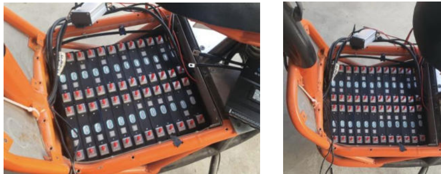
ภาพที่ 8 นำแบตเตอรี่ลิเทียมไอออน NMC 100 โวลต์ 58 แอมแปร์ต่อชั่วโมง บรรจุลงในรถ
