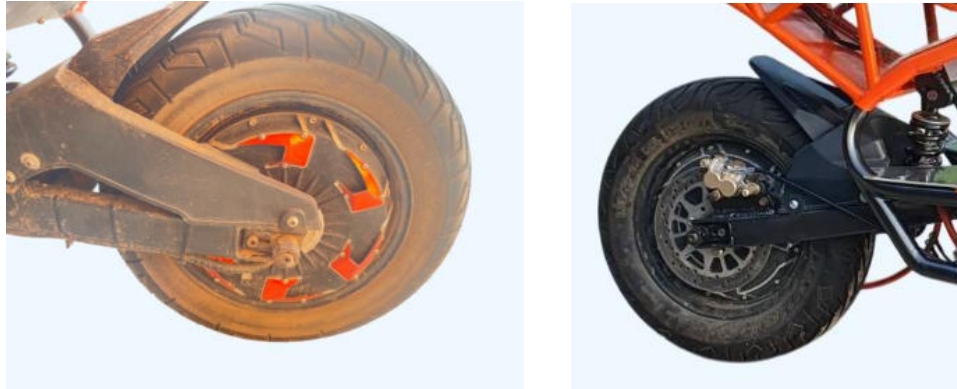
ภาพที่ 10 มอเตอร์ไฟฟ้ากระแสตรงแบบไร้แปรงถ่าน 72-120 โวลต์ 3,000 วัตต์ ที่ขนาดวงล้อ 12 นิ้ว
