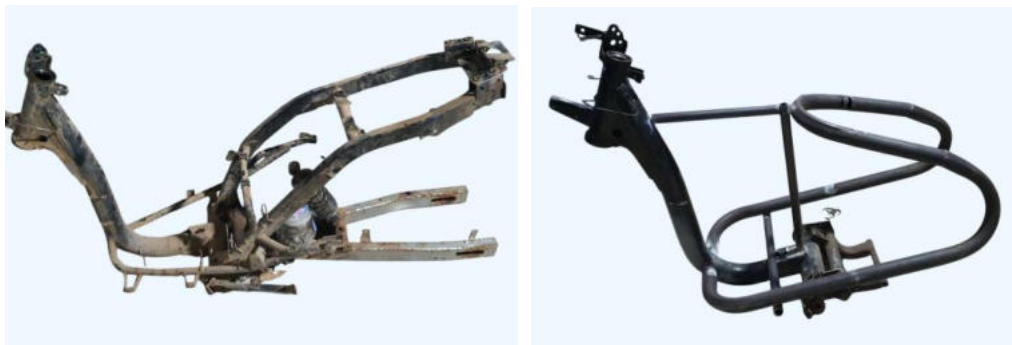
ภาพที่ 2 นำรถโครงรถจักรยานยนต์ HONDA ICON รุ่นปี 2007 มาดัดแปลงโครงรถขึ้นมาใหม่
