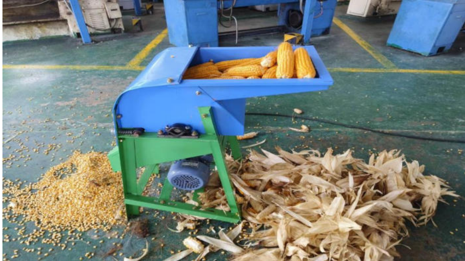
ภาพที่ 2: ทดสอบหาประสิทธิภาพเครื่องแยกเมล็ดข้าวโพดเลี้ยงสัตว์
