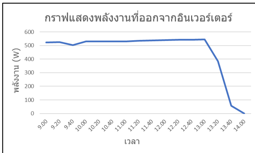
กราฟที่ 3 แสดงพลังงานกระแสไฟฟ้าที่ออกจาก อินเวอร์เตอร์ผลการทดสอบการทำงานของแผง Solar Cell ขนาด 1100 วัตต์ จ่ายเข้าแบตเตอรี่ 72 โวลต์ 20 แอมป์ 1 ก้อน
