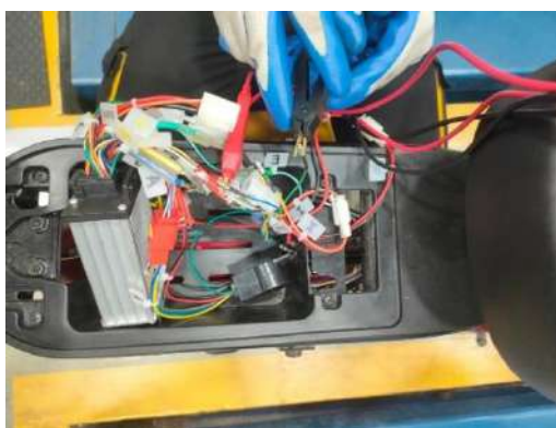
ภาพ 5 การวัดสายสัญญาณ ใช้เครื่องชื่อว่า คลิปแอมป์ดิจิตอล
