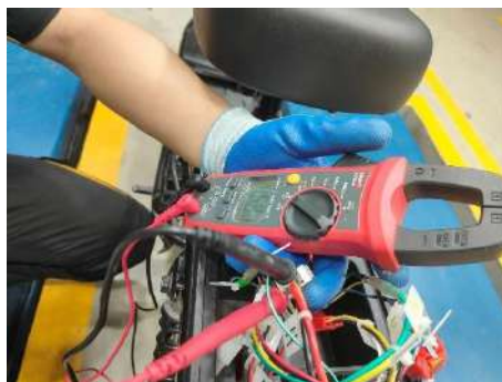
ภาพที่ 4.4 การวัดแรงไฟดันมอเตอร์ใช้เครื่องคลิปแอมป์ดิจิตอล
