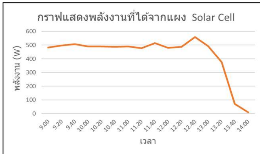
กราฟที่ 1 แสดงพลังงานที่ได้จากแผง Solar Cell ผลการทดสอบการทำงานของแผง Solar Cell ขนาด 1100 วัตต์ จ่ายเข้าแบตเตอรี่ 72 โวลต์ 20 แอมป์ 1 ก้อน
