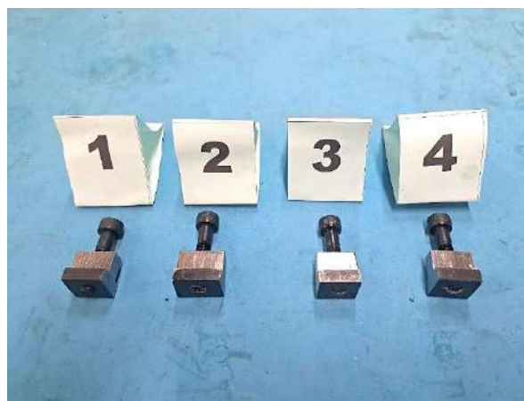
รูปที่ 5 ผลลัพธ์ที่เกิดจากการเรียนรู้ ผู้เรียนมีทักษะในการตัดเกลียวใน ตามแบบงานที่กำหนดและได้ตรงตามมาตรฐาน
