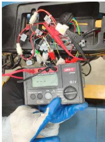
ภาพ 4.2 การวัดค่าความเป็นฉนวนของสายไฟใช้เครื่อง Insulation Resistance Testers
