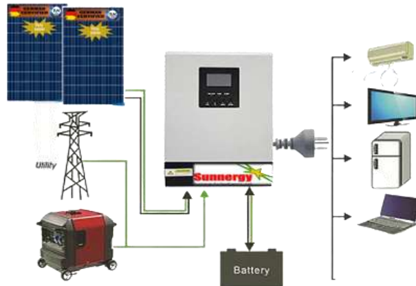
ภาพที่ 3: วงจรไฟฟ้าของชุดสาธิตการติดตั้งโซล่าเซลล์ระบบ ไฮบริด ขนาด 500 วัตต์ ที่มา: ( https://www.sunnerytech.com )
