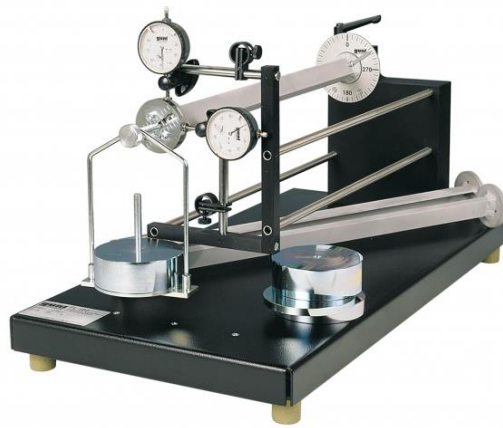
ภาพที่ 5 ชุดทดลองการหาระยะแอ่นของคาน
