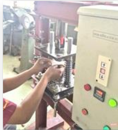
ภาพที่ 4 แสดงการทดลองอัดกระถางที่อุณหภูมิและเวลาต่างๆ
