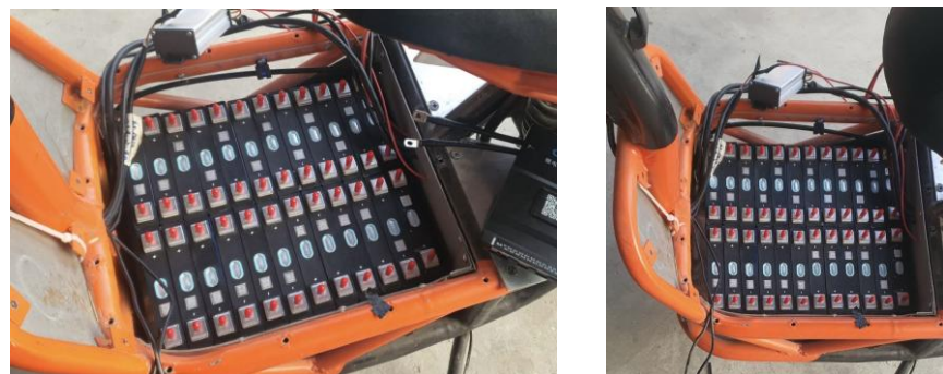
ภาพที่ 8 นำแบตเตอรี่ลิเทียมไอออน NMC 100 โวลต์ 58 แอมแปร์ต่อชั่วโมง บรรจุลงในรถ
