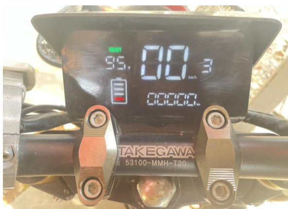
ภาพที่ 6 ตำแหน่งของหน้าจอแสดงผล LED หรือเรือนไมล์
