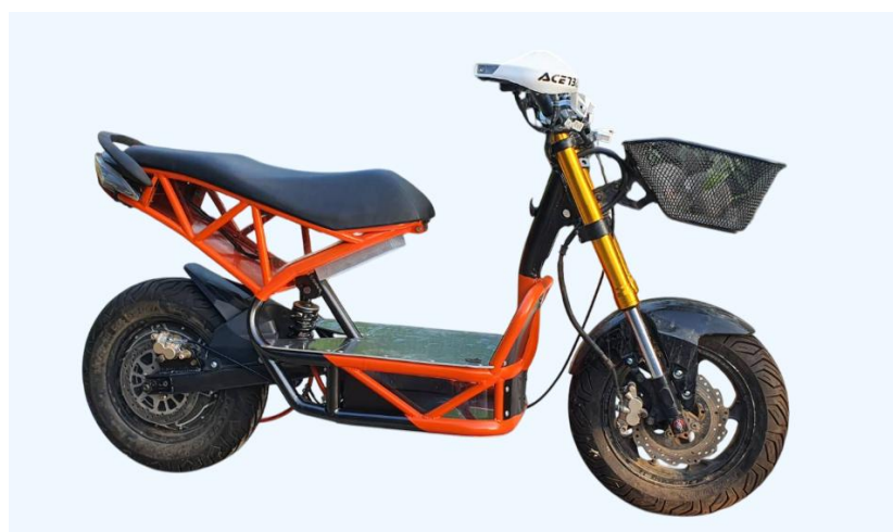
ภาพที่ 11 รถจักรยานยนต์ไฟฟ้าดัดแปลงที่สร้างขึ้น
