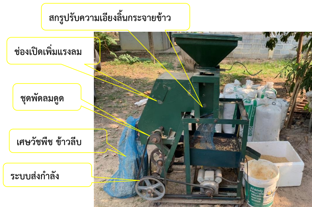
ภาพที่ 3 : ส่วนประกอบเครื่องคัดแยกเมล็ดข้าวเปลือกโดยใช้ตะแกรงร่อนร่วมกับระบบลมดูด
