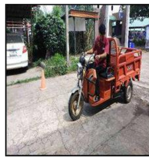
รูปที่ 6-7 ทดสอบหาระยะทางต่อการชาร์จแบตเตอรี่ของรถบรรทุกสามล้อไฟฟ้าดัดแปลง
